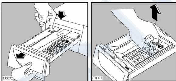
Стиральный порошок скапливается и в углублении дозатора. Для чистки углубления можно использовать старую зубную щетку. После чистки установите дозатор на место, и включите программу стирки без белья.
